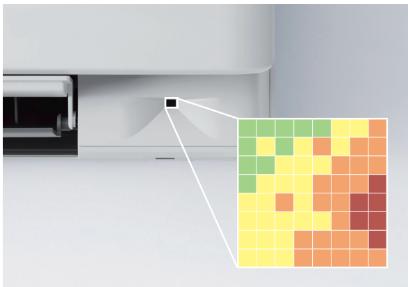
Värmekamera mäter ytemperaturen i ett rum genom att dela upp det i ett nät med 64 olika rutor.
